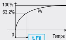
Constante de temps, en secondes, du filtre RC de l'entrée mesure PV.
