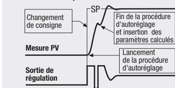
**Ce mode est sélectionné lorsque l'écart entre la mesure PV et la consigne SP est supérieur à 5% de l'échelle PV.** Cette méthode permet un calcul simple et rapide.
