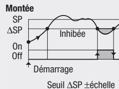
E - Alarme Rupture de Boucle LBA (Loop Break Alarm) et/ou Rupture Capteur
