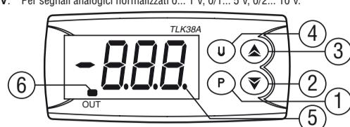
1. **(P)**: Utilizzato per accedere alla programmazione dei parametri di funzionamento e per confermare la selezione.
