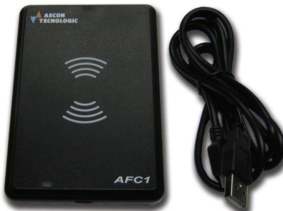
Cuando el instrumento está equipado con la opción de comunicación **NFC**, la configuración de parámetros realizada con el programa "*AT UniversalConf*" (ver el párrafo anterior) puede transferirse al instrumento también a través del dispositivo **AFC1**. Para cargar los parámetros operativos en el instrumento usando el dispositivo **AFC1**, coloque el controlador sobre el **AFC1** con la pantalla orientada hacia el símbolo **NFC** (☺), luego envíe los parámetros a la memoria del instrumento.
