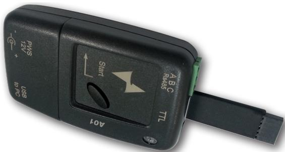
Diese Einrichtung wird zur serienmäßigen Programmierung von Geräten verwendet, die alle über die gleiche Parameterkonfiguration verfügen sollen bzw. zur Sicherung einer Kopie der Programmierung eines Gerätes, damit diese schnell wiederhergestellt werden kann.
