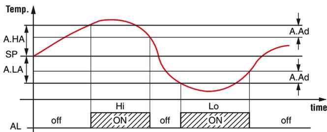
Les alarmes de température de maximum et de minimum peuvent être déconnectées en établissant les paramètres relatifs "RHR" et "RLR" = 0F.
