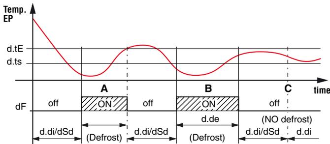
**Exemples du fin dégivrage:** le dégivrage **A** termine pour la réalisation de la température “ $d_tE$ ”, le dégivrage **B** termine à la fin du temps “ $d.de$ ” car la température “ $d_tE$ ” n’est pas réalisée, le dégivrage **C** ne s’effectue pas car la température est supérieure à “ $d_tS$ ”.
