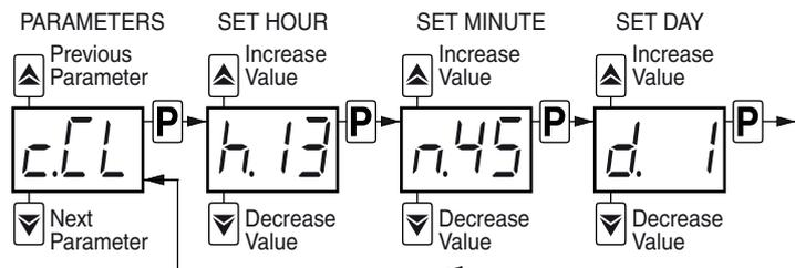
Sélectionner le paramètre "c.L.L" et appuyer sur [P] plusieurs fois pour régler dans l'ordre :
