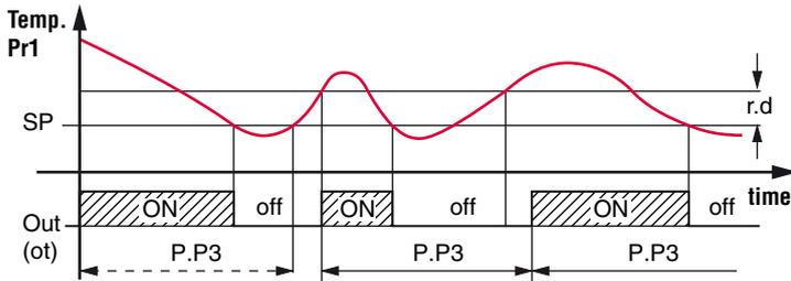
Pendant toutes les phases d'interdiction causées par les protections, le LED de la sortie (☼ ou ☼) est **clignotant**.
