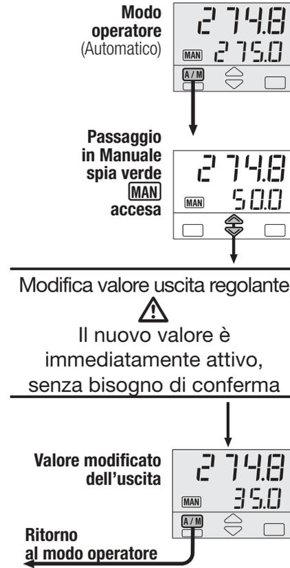
In Manuale il Setpoint è accessibile e modificabile mediante la procedura di visualizzazione (cap. 5 pag.49). La transizione AUTO/MAN o MAN/AUTO avviene con azione bumpless.
