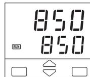
Con el Temporizador en funcionamiento, el LED  $\boxed{RUN}$  está encendido.
