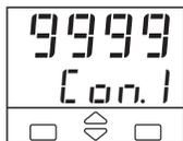
O aparelho se mantém em estado de espera, com entradas e saídas desativadas, até a imposição do código de configuração desejado.
