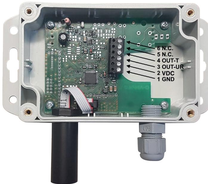
**Tensione di alimentazione:** 9 ÷ 30 VDC;
