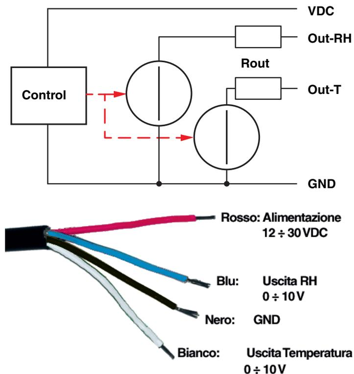
**Tensione di alimentazione:** 12 ÷ 30 VDC;
