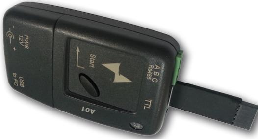
El dispositivo **A01** es utilizable para la programación en serie de instrumentos que tienen que tener la misma configuración de los parámetros o para guardar una copia completa de la programación de un instrumento y poderla retransferir rápidamente.
