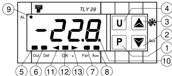
**1 - Taste P:** Wird zur Eingabe des Sollwertes und zur Programmierung der Betriebsparameter verwendet
