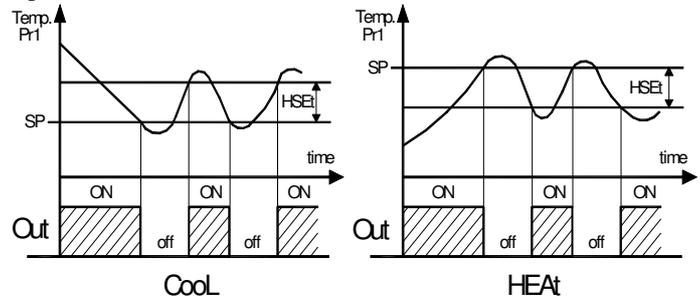
Bei einer Störung des Zellfühlers (Pr1) kann der Ausgang "Out" derart programmiert werden, dass er nach den im Parameter "tonE" (Einschaltzeit) und "toFE" (Abschaltzeit) eingegebenen Zeiten weiter funktioniert.
