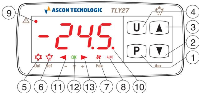
**1 - Touche P:** Utilisée pour la programmation du Set point et pour la programmation des paramètres de fonctionnement.
