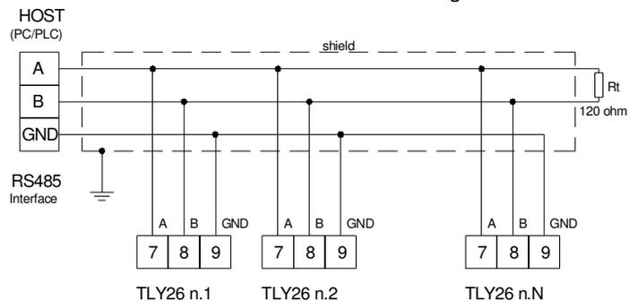
Si l'instrument est muni d'interface série, les paramètres suivants doivent être programmés, tous disponibles dans le groupe de paramètres "SER" :
