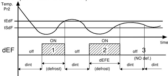
**Beispiele:** Der Abtauzykus 1 endet, nachdem die Temperatur "tEdF" erreicht wurde, der Abtauzykus 2 endet nach Ablauf der Zeit "dEFE", da die Temperatur "tEdF" nicht erreicht wurde, der Abtauzykus 3 beginnt nicht, da die Temperatur höher als "tSdF" ist.
