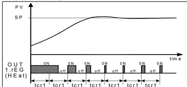
Per ottenere una buona stabilità della variabile in caso di processi veloci, il tempo di ciclo "tcr1" deve avere un valore basso con un intervento molto frequente dell'uscita di regolazione.
