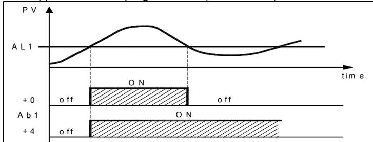
*Nell'esempio il comportamento è rappresentato con un allarme di massima assoluta*
