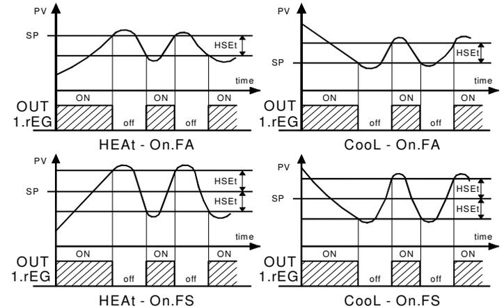
Il regolatore si comporta nel seguente modo: in caso di azione inversa, o di riscaldamento ("Func"=HEAt), disattiva l'uscita 1.rEG quando il valore di processo raggiunge il valore [SP + HSEt] nel caso di isteresi simmetrica oppure [SP] nel caso di isteresi asimmetrica, per riattivarla quando scende sotto al valore [SP - HSEt].
