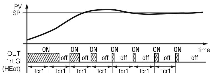
Pour obtenir une bonne stabilité de la variable dans le cas de procédés rapides, le temps de cycle "tcr1" doit avoir une valeur basse avec une intervention très fréquente de la sortie de réglage.
