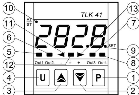
**1 - Touche P:** Utilisée pour accéder à la programmation des paramètres de fonctionnement et pour confirmer la sélection.
