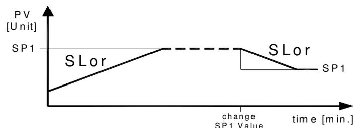
Si en cambio se desea realizar un ciclo automático del encendido del instrumento hace falta programar el par. "nSP" = 2, programar los dos valores "SP1" y "SP2" y naturalmente programar los pares. "SLor", "dur.t" y "SLoF" con los valores deseados.
