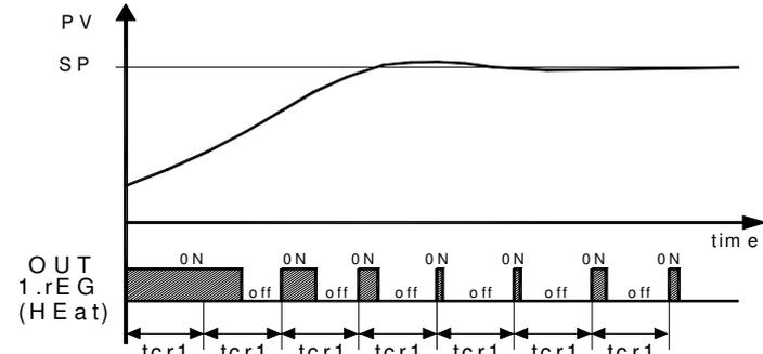
Para conseguir una buena estabilidad de la variable en caso de procesos rápidos, el tiempo de ciclo "tcr1" debe tener un valor bajo con una intervención muy frecuente de la salida de regulación.
