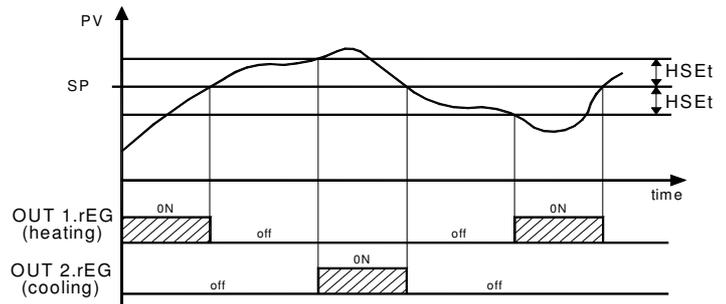
Si la salida 2.rEG se usa para el control de un compresor es posible usar la función "Protección del Compresor" que tiene la función de evitar ciclos cortos.
