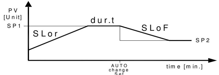
Ejemplos con valores de salida inferior a SP1 y con disminución del Set Point.
