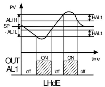
"Ab1" - CONFIGURACIÓN DE LA ALARMA: El parámetro puede asumir un valor comprendido entre 0 y 31.
