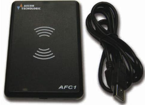
Per la configurazione mediante **NFC** non è necessario alimentare lo strumento ma è sufficiente mettere a contatto la parte frontale dello strumento dove si trova il display sul simbolo (NFC) del dispositivo **AFC1** (che viene alimentato direttamente dalla porta **USB** connessa al PC) o sulla parte dello smartphone sulla quale si trova l'interfaccia **NFC** (per questo consultare il manuale d'uso dello smartphone).
