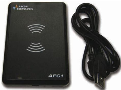
Pour configurer l'instrument avec **NFC** il n'est pas nécessaire d'alimenter la minuterie, mais il suffit de placer sa face avant sur le symbole (NFC) depuis la surface de l'appareil **AFC1** (qui s'alimente directement depuis le port **USB** connecté au **PC**) ou sur le partie du smartphone sur laquelle il se trouve l'interface **NFC** (pour cela consulter le manuel d'utilisation du smartphone) puis envoyer les paramètres dans la mémoire de l'instrument.
