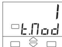
Le paramètre "Mode de fonctionnement Timer/Start-up"
