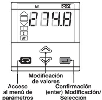
El proceso de ajuste de parámetros tiene un temporizador. Si durante al menos 30 segundos no se pulsan teclas, el regulador vuelve automáticamente al nivel de operador.
