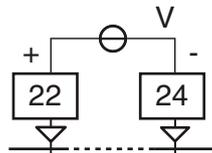
Sortie V: 0/2... 10 V, séparation galvanique, résistance de charge minimale: 500Ω.
