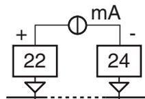
Sortie mA: 0/4... 20 mA, séparation galvanique, résistance de charge maximale: 500Ω.
