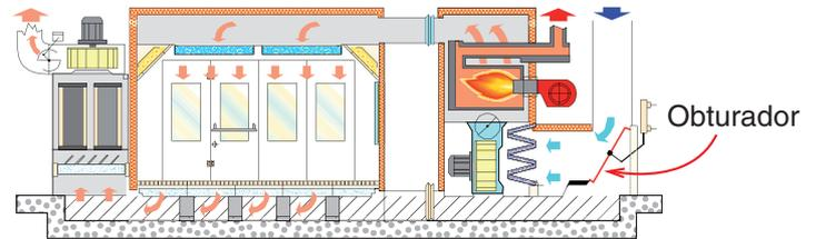
Durante las fases de pasivación y secado, el operador está fuera de la cabina el sistema cierra el obturador del aire y recicla el aire interno con el fin de reducir el consumo de potencia.
