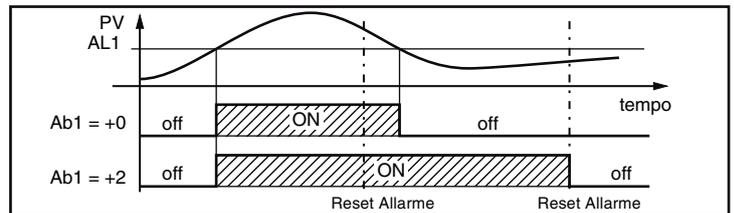
3. La alarma “conocida” es una alarma que puede ser reseteada aun cuando la condición que la ha generado persiste. La alarma conocida puede ser realizada solo mediante comando externo (tecla U, entrada digital o comunicación serie).
