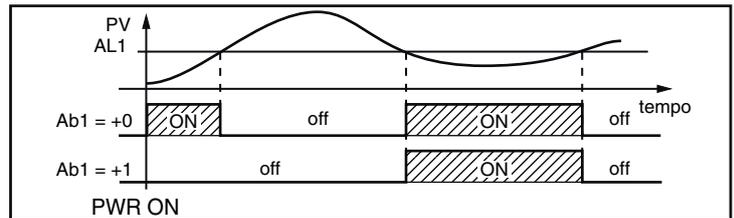
2. La alarma enclavada (reset manual) es una alarma que permanece activa aún si la condición que genera la alarma no persiste más. El reset de alarma puede ser realizada solo con el comando externo (tecla U, entrada digital o comunicación serie).
