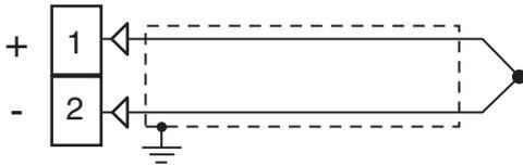
**Resistencia externa:** 100Ω max., error máximo 0.5% del span.
