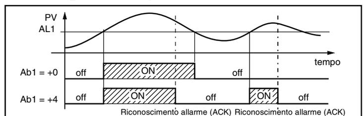
4. La "Alarma relativa no activa al cambio de set point" es una alarma que oculta la condición de alarma después de un cambio de set point hasta que la variable de procesos alcance el umbral más o menos la histéresis.
