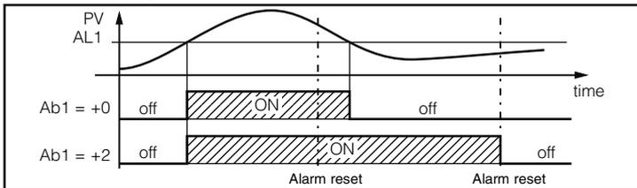
3. Une alarme "rendue silencieuse" est une alarme qui peut être remise à zéro même si la condition qui a engendré l'alarme est encore présente. La reconnaissance de l'alarme peut s'effectuer seulement par une commande externe (poussoir
