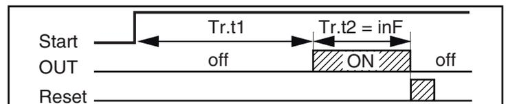
Retard à la mise en fonction avec un temps de retard et un temps de "fin de cycle".
