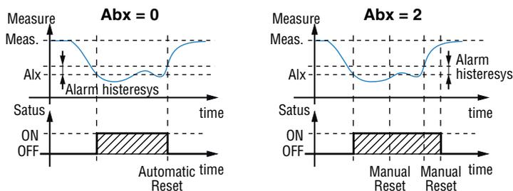
3. Un allarme "tacitabile" è un allarme che può essere resettato anche se la condizione che ha generato l'allarme è ancora presente. Il riconoscimento dell'allarme può avvenire solo tramite un comando esterno (pulsante , ingresso logico o interfaccia seriale).
