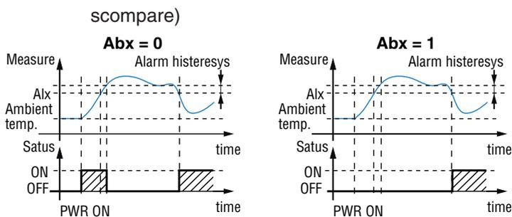
2. Un allarme memorizzato (reset manuale) è un allarme che rimane attivo anche quando la condizione di allarme che lo ha generato non è più presente. Il reset dell'allarme può avvenire solo tramite un comando esterno (pulsante , ingresso logico o interfaccia seriale).
