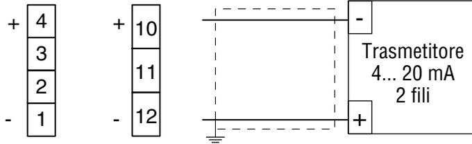
**Collegamento ingresso da 0/4... 20 mA per trasmettitore passivo con alimentazione ausiliaria esterna**
