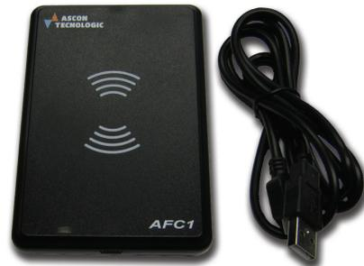
Per la configurazione dello strumento con il dispositivo **AFC1** è necessario appoggiare lo strumento sul lato indicato con l'apposito simbolo sul dispositivo AFC1 il quale viene alimentato direttamente dalla porta USB connessa al PC.
