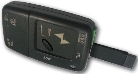
Il dispositivo **A01** è utilizzabile per la programmazione in serie di strumenti che devono avere la stessa configurazione dei parametri o per conservare una copia della programmazione di uno strumento e poterla trasferire rapidamente ad altri. L'A01 consente la connessione tramite porta USB ad un PC con il quale, mediante l'apposito software di configurazione per strumenti "AT UniversalConfig", è possibile configurare i parametri di funzionamento.
