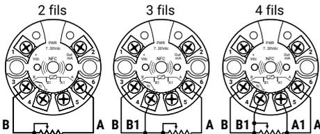
**Note:** Le potentiomètre 4000 Ω peut uniquement être connecté en mode 2 fils.
