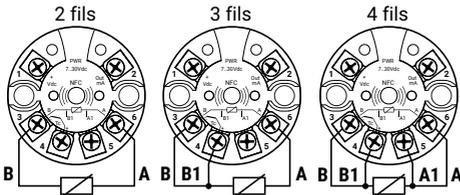
**Note:** La sonde PT1000 ne peut être connectée qu'en mode 2 fils.
