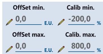
Che permette di modificare la calibrazione definendo un **Offset** applicato al punto di inizio scala che si desidera usare ed un secondo **Offset** applicato al punto di fondo scala.
