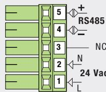
**Alimentation:** Alimentation à découpage à double isolement avec PTC (fusible réarmable) incorporé.
