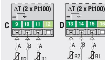
⚠ Avec une distance de 15 m entre la sonde et le régulateur et un câble de 1.5 mm<sup>2</sup> de section, l'erreur est de environ 1°C (1°F)
