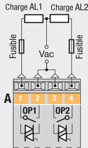
Les sorties OP1 et OP2 peuvent être utilisées en alarmes si elles ne sont pas configurées en sorties régulation
