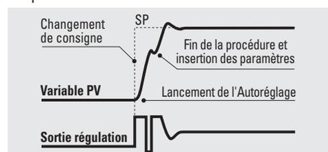
La procédure d'Auto-réglage par **fréquence naturelle** du procédé est utilisée quand, au lancement, la mesure est quasiment égale à la consigne. Les paramètres PID sont calculés à partir d'une oscillation du procédé autour de la consigne. Le principal avantage de cette méthode est la réduction des perturbations sur le procédé.
