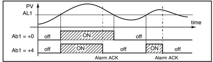
Une "Alarme relative inactive au changement de consigne" est une alarme qui masque les conditions d'alarme après un changement de point de consigne jusqu'à ce que la variable ait atteint le seuil d'alarme ± hystérésis.
