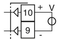
Sortie V: 0/2... 10 V, isolée, RL min.:  $500 \Omega$ .
