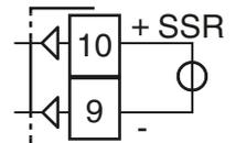
Niveau logique 0:  $V_{out} < 0.5 \text{ VDC}$ ;
