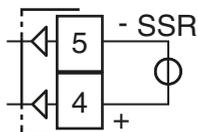
**Niveau logique 0:**  $V_{out} < 0.5 \text{ VDC}$ ;
